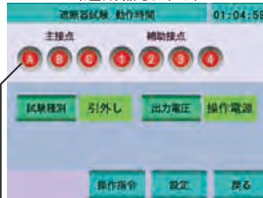
試験開始画面 (遮断器引外し)
