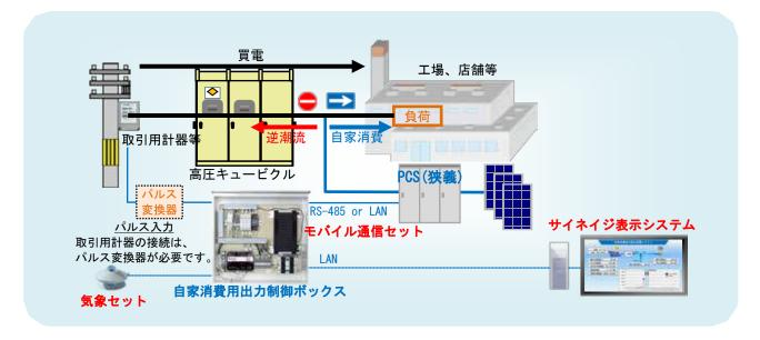
本システムは、晴天条件における太陽光発電システムの最大出力容量を制御するシステムです。 天候を考慮した制御は行いませんので、実際の発電量は日射量によります。 本システムは、通信 I/F による出力能力を制御できる PCS(狭義)が必要です。 また、蓄電池システムとの組合せが可能です。詳細はお問合せお願い致します。
