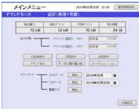
メイン画面 現在電力、デマンド、予測デマンドなどを表示
